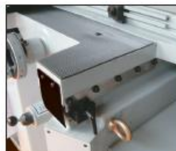
鞍座前後運動之鎖固裝置於切槽或其他端面研時使用，操作簡便、精度高。
