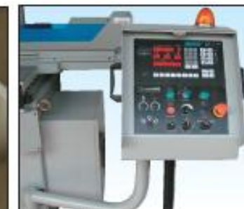
兩層轉輪設計的操作箱與支架，可任意調整操作角度，非常方便。
