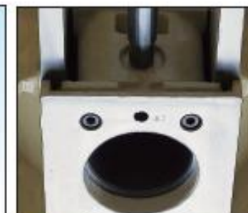
上下進給滑台單元採板式設計，自動給油潤滑，可耐久使用。
