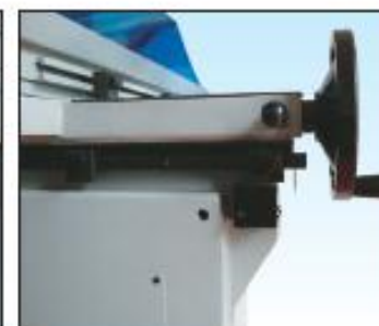
前後自動進刀行程調整機構，調整容易，非接觸式感應開關壽命長。
