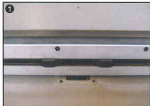
● 內藏式近接開關及輕易調整左右行程之牽動具。
