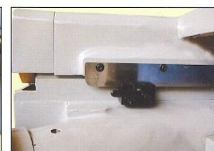
⑥ 鞍座前後運動之鎖固裝置，適用於上下直進(切斷、溝槽)研磨。
