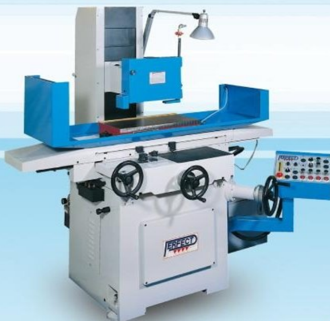
PFG-CL 3060AH 300 x 600 mm. 工作台面積
