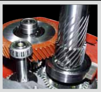
5HP 重切削機頭組，高低檔變速由後列齒輪傳動（一般為齒型皮帶）
