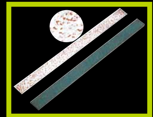
嚴格的鏟花要求（每平方英寸均有 16 點的接觸點，將精度提高並延長耐用年限） XY 軸嵌條加貼耐磨板
