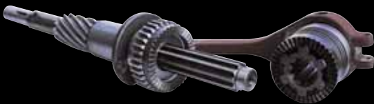
1. 自動進刀離合器中碳鋼高週波熱處理一體成型 2. 主軸自動進刀專利設計以六栓槽式支撐，機構穩固、傳動結實
