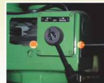
可調式鍊條煞車柄設計 增長煞車皮壽命(有段頭)
