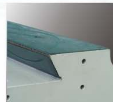
XY軸兩面及鳩尾滑道均貼耐磨版
