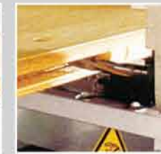
Horizontal side milling 橫向側銑加工
