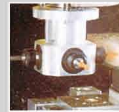
Cross side boring 十字側鉗加工
