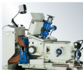
JHC-18 調整輪以 10 段變速之變速箱驅動。
