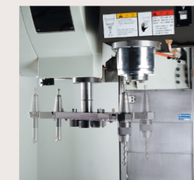
夾鬆刀機構 (USC-5T) 同步快速夾鬆刀。
