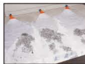
沖屑裝置(選購配備) 高壓沖屑裝置，可徹底 將切屑清除。
