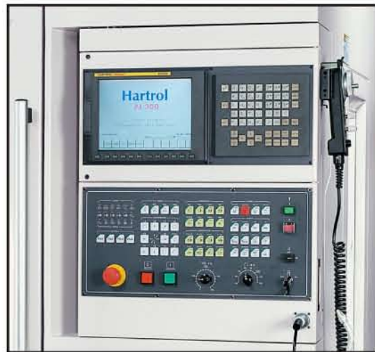
操作面板符合人體工學 薄膜式操作面板，使操控更得心應手。
