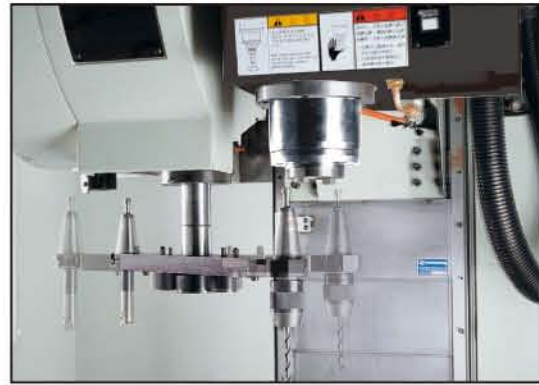
鎖刀退刀機構 特殊同步退刀設計，動作順暢。
