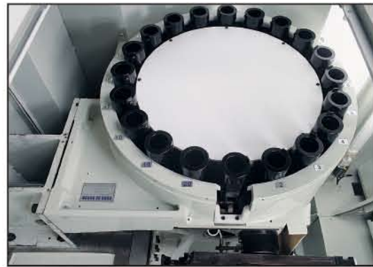
刀臂式刀庫 刀臂式刀庫之儲刀量為24支刀， 選刀方式為雙向任意式選刀。
