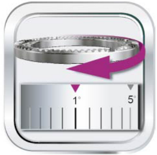
角度頭C軸1度定位機構(TWC)
