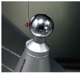
AC萬向頭旋轉中心 +刀尖誤差自動量測功能
